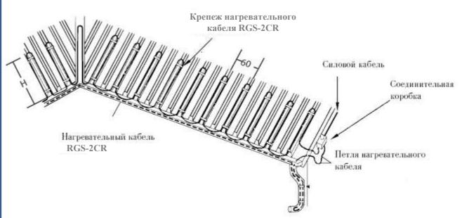
Прикреплять с помощью шурупов, используя уплотнительную прокладку. Расстояние может варьироваться в зависимости от дизайна ребра крыши. Обычно рекомендуется повторить очертания всех ребер (рельефных выступов).
